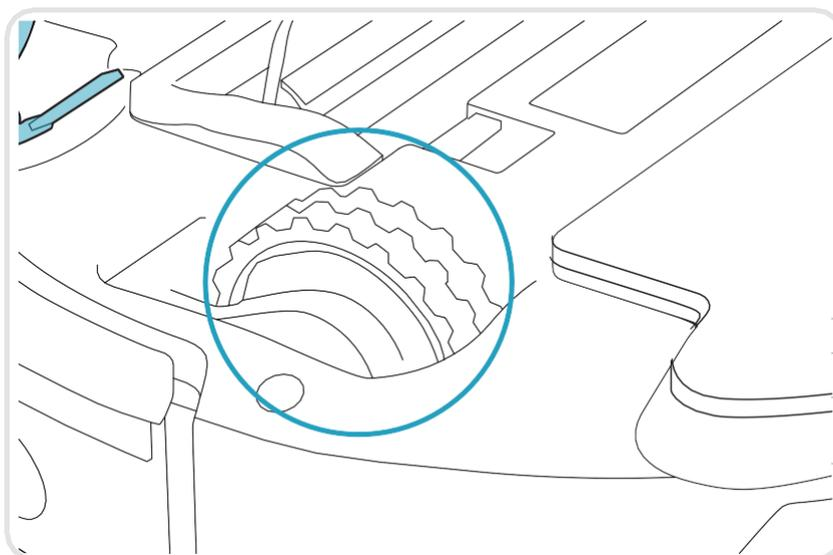
**2.** Se la ruota anteriore dovesse rimanere bloccata, rimuoverla con attenzione utilizzando un piccolo cacciavite e pulire la ruota.
