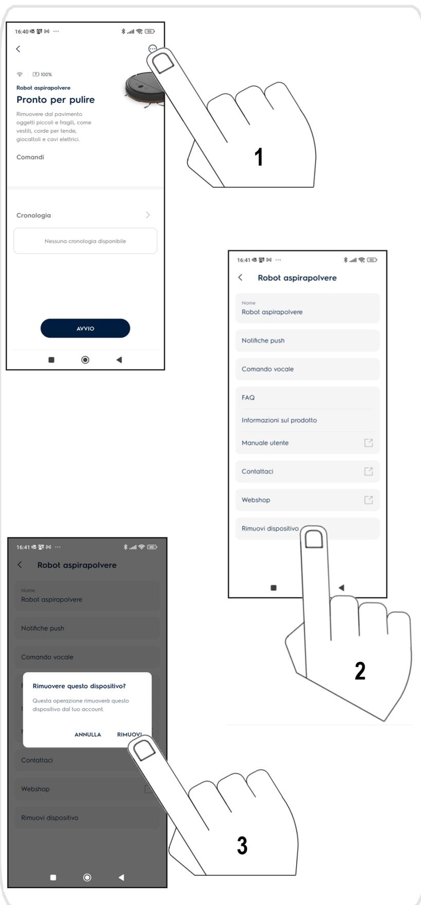
**5.** Per riconnettere il robot mantenerlo fuori dalla base di ricarica, sul pavimento e premere contemporaneamente e mantenere premuti, il pulsante on/off e home fino all'emissione di un segnale acustico, quindi rilasciare i pulsanti. Seguire poi le istruzioni direttamente dalla app. Una volta connesso sarà completamente controllabile direttamente dalla app.
