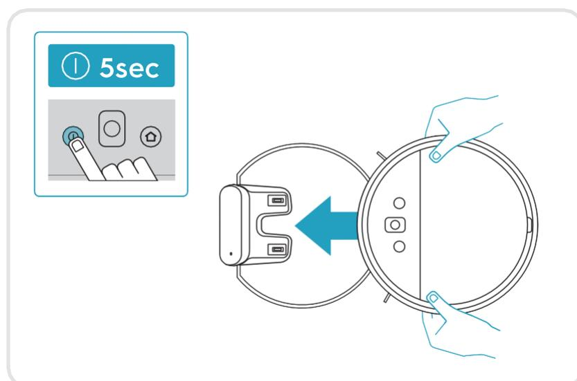
Per riavviare il robot, inserirlo nuovamente nella base di ricarica. È anche possibile spegnerlo nella base di ricarica, poi è necessario sollevarlo e rimetterlo nella base di ricarica per usarlo
