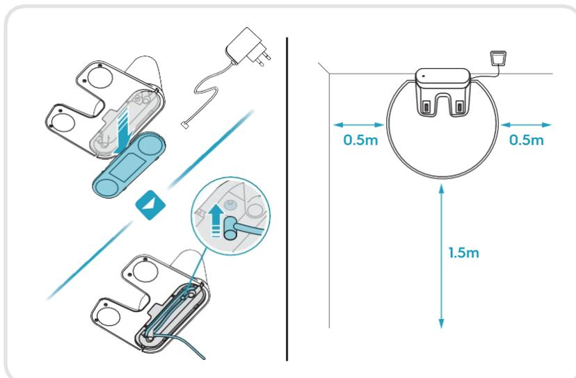
**Nota:** posizionare la base nel raggio d'azione del router WiFi.
