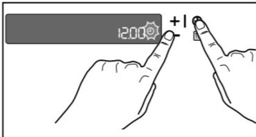
Lorsque le four est en fonctionnement, le mode Démo est activé si le symbole
